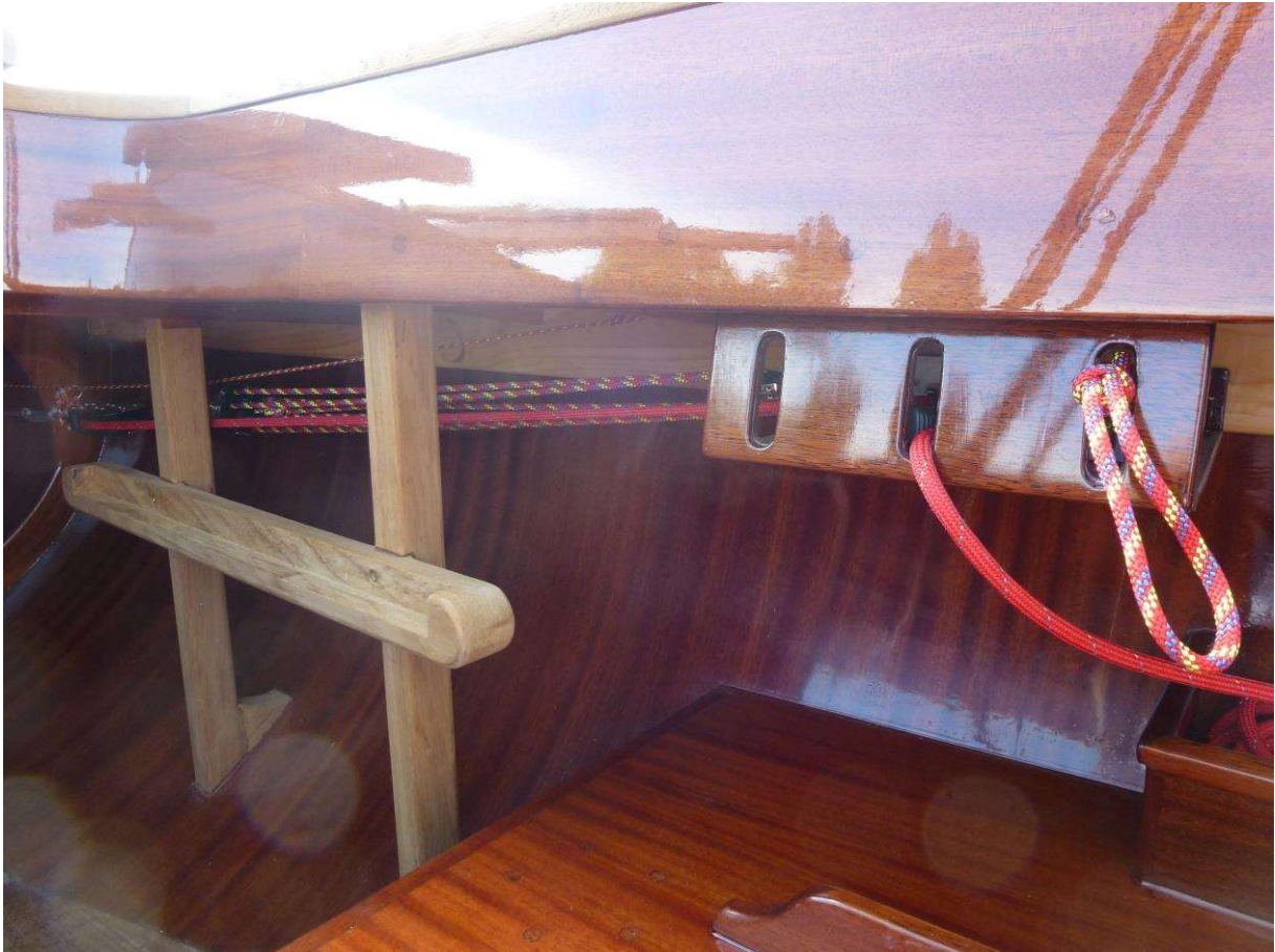
Elegante Klemmen-Box für Achter- und Backstage, Trimmleinen für Holepunkte und Barberholer
