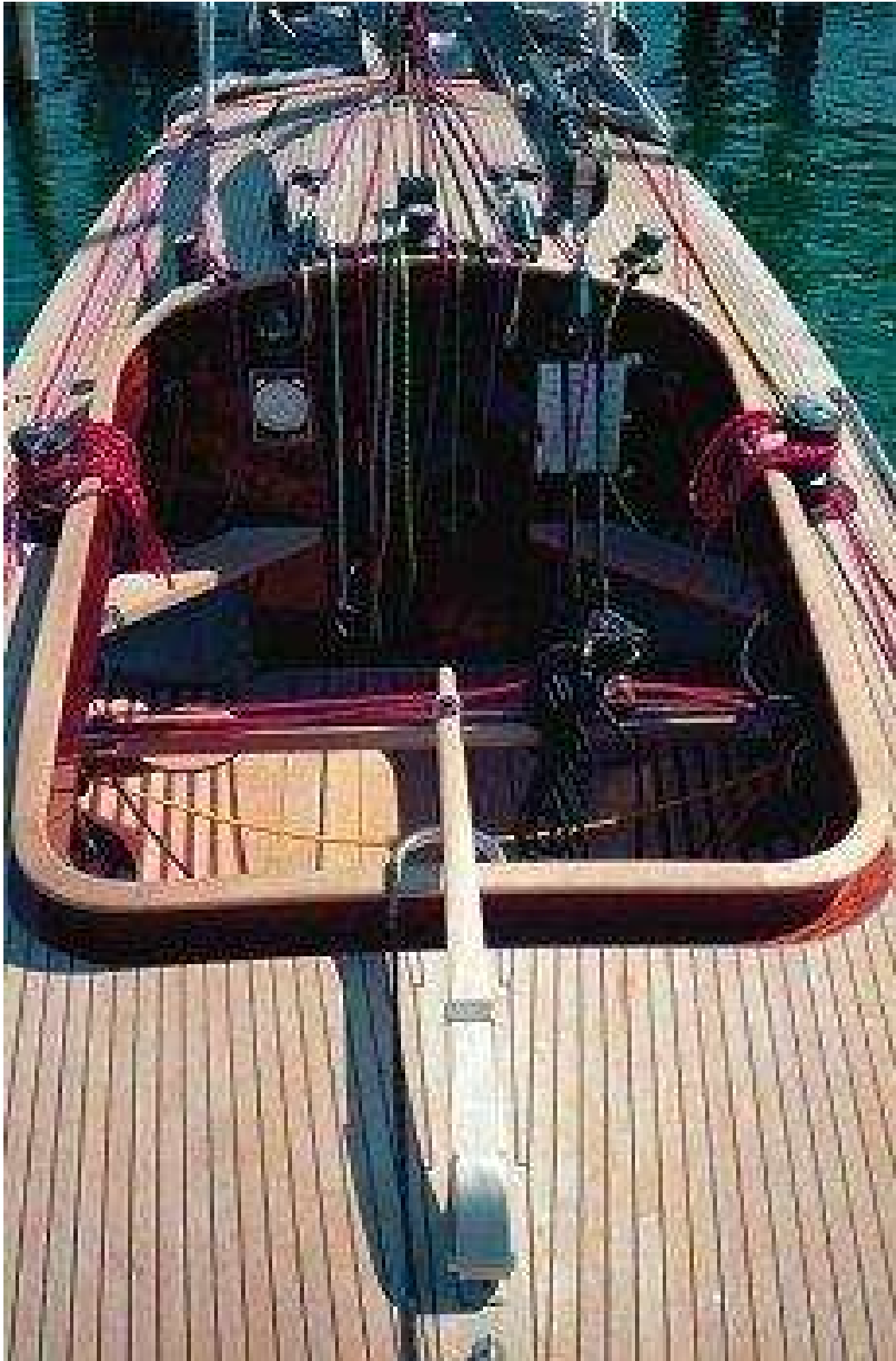
Regatta-Cockpit ohne Schiebeluk, smarte Trimm- Sitze
