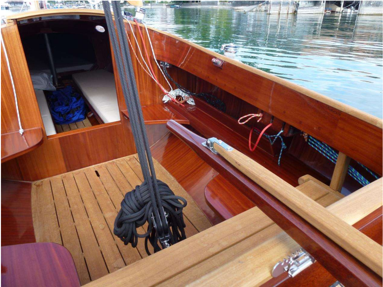
Cockpit ohne Backskiste mit vier festen Sitzen und Ablage dahinter
