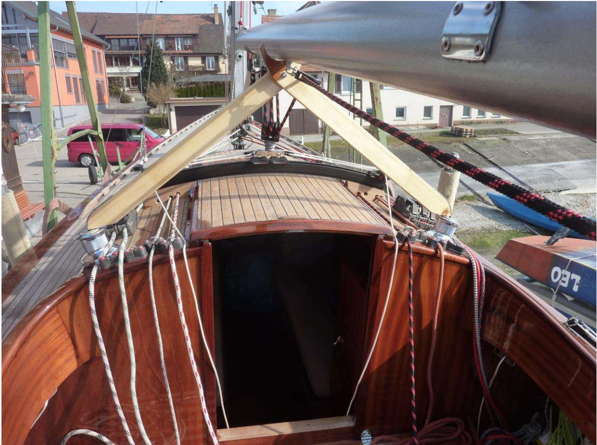
Großschot-Traveller auf dem Kajütdach
