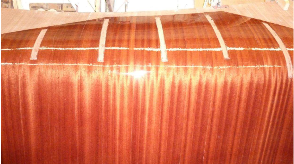
Rumpfhälfte Innenseite beim Beschichten
