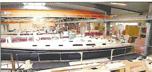
Rumpf und Deck der HANSE 411 werden als leichte und feste Sandwichkonstruktion im Handauflegeverfahren laminiert. Sie sind
